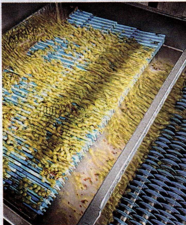
Die Beeren fallen durch, der Rest wird weitertransportiert.
